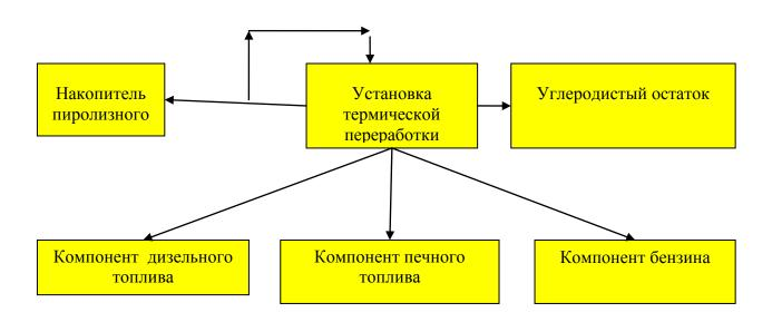
Процесс термической деструкции пластмасс осуществляют в двух попеременно работающих реакторах. Вторичную пластмассу, прошедшую предварительную подготовку (дробление, омывку, флотацию, грунулирование или агломерацию), загружают в реактор в количестве 2 тонн.
